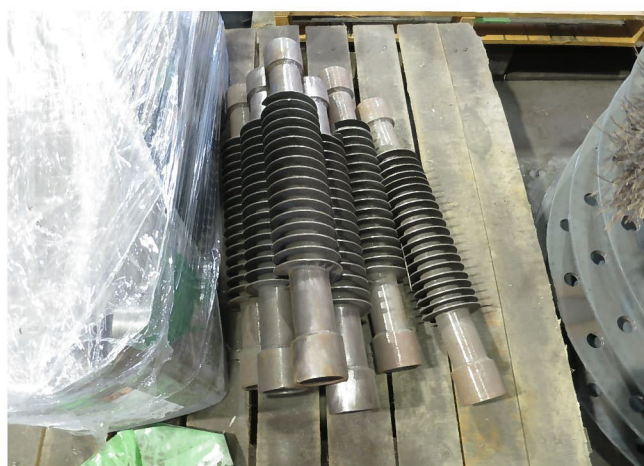
ヒーティングパイプ
