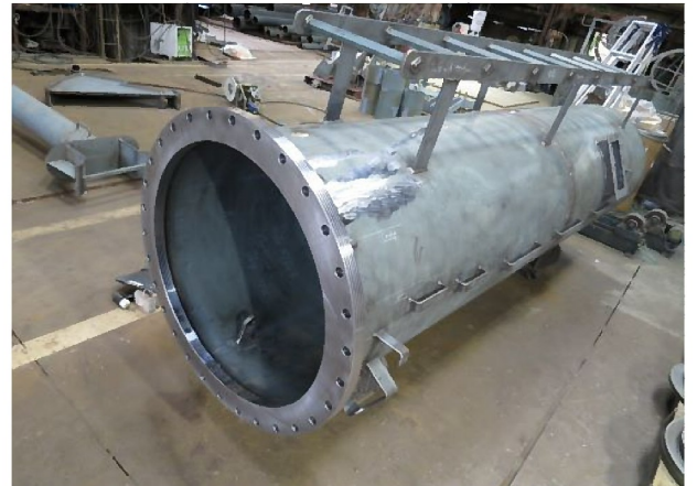
クレーンポスト(製作中)
