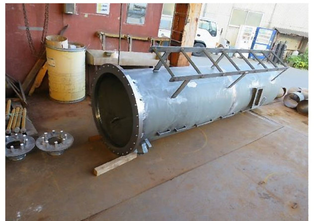
クレーンポスト(製作中)
